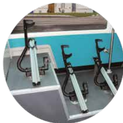
Poggyász- és kerékpártartó állványok: az ügyféligények alapján kifejlesztett és az adott üzemelési körülmények szerint kialakított, speciális felszerelések.
